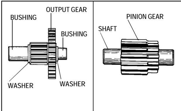
7. **OUTPUT PINION AND SHAFT**
