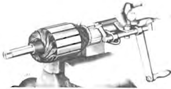
Fig. 19—Undercutting Mica
