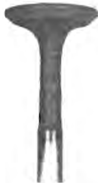
Fig. 3—Valve Stem Corrosion
