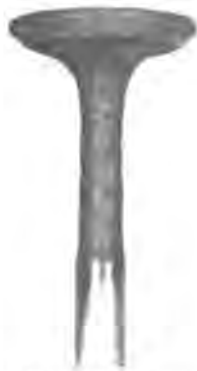
Fig. 3—Valve Stem Corrosion
